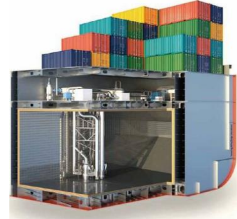
LNG Tank & FGSS
